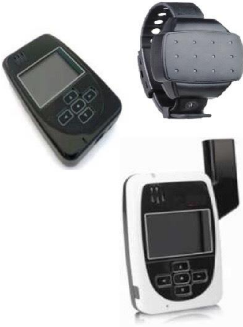
Obr. 1.: Technické zariadenie na kontrolu výkonu rozhodnutia zákazu priblíženia sa kontrolovanej osoby k chránenej osobe
