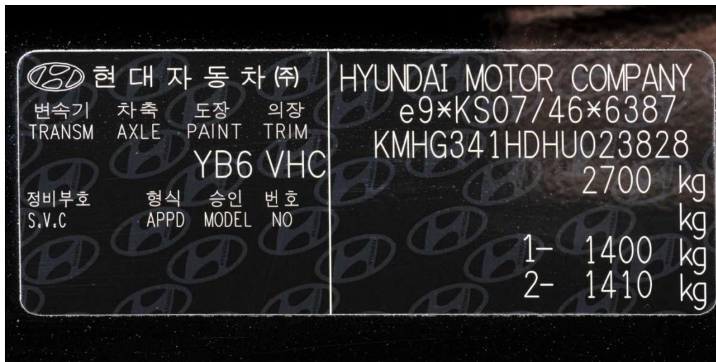
Obr. 3 Ukázka opticky variabilního prvku – logo Hyundai, které je viditelné jen pod určitým úhlem dopadajícího světla. V logu (pravá nožička písmena H) je zároveň použit ochranný prvek „mikrotext“, ve kterém je napsáno slovo „Hyundai“.
