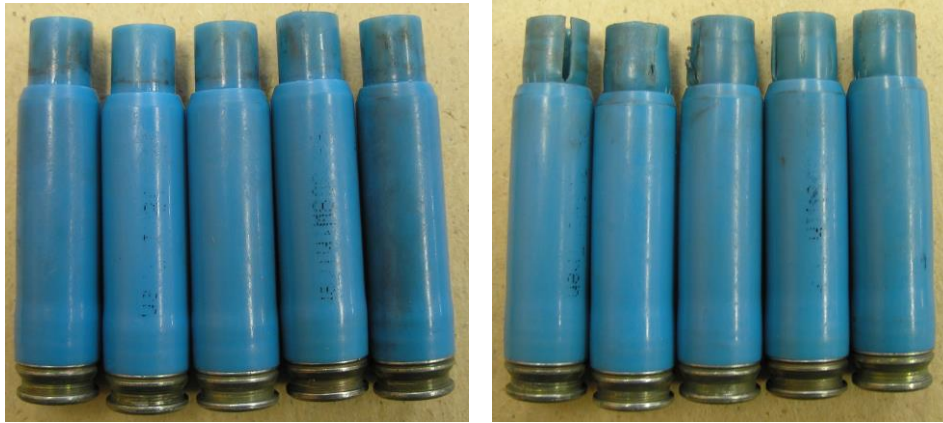
Obrázek 6 Porovnání stavu plastových nábojnic redukovaného puškového náboje ráže 7,62 x 51, série DAG 96H0629 po výstřelu. Vlevo – nábojnice vystřelené z balistické hlavně, vpravo – nábojnice vystřelené z pušky Mauser „Erfurt“, model 98. Zdroj: Juříček, L., 2016.
