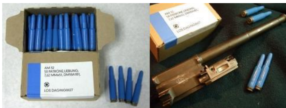
Obrázek 1 Vlevo – puškové redukované náboje ráže 7,62 x 51 (Plastic Training Ammunition). Vpravo – konverzní díly na útočnou pušku G 3 (Heckler & Koch). Zdroj: Juříček, L., 2016.
