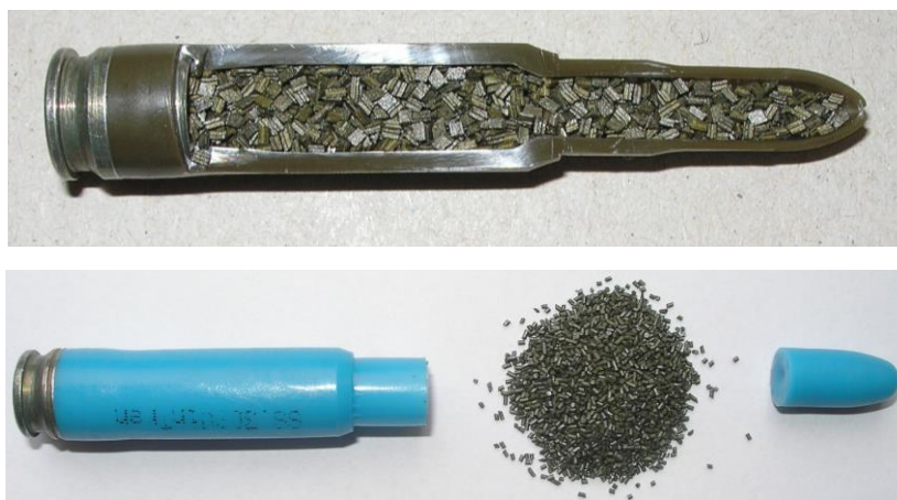
Obrázek 4 Puškové plastové náboje ráže 7,62 x 51. Nahoře – cvičný puškový náboj, dole – redukovaný náboj s oddělenou plastovou střelou a vysypaným bezdýmným prachem. Zdroj: Juříček, L., 2016.
