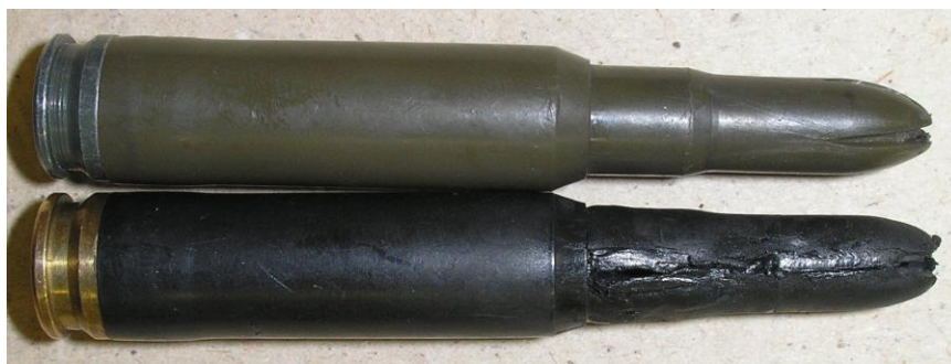
Obrázek 11 Vystřelené puškové plastové cvičné náboje. Nahoře – tmavě zelený náboj vystřelený z balistické hlavně, dole – černý náboj vystřelený z pušky Mauser „Erfurt“, model 98. Zdroj: Juříček, L., 2016.
